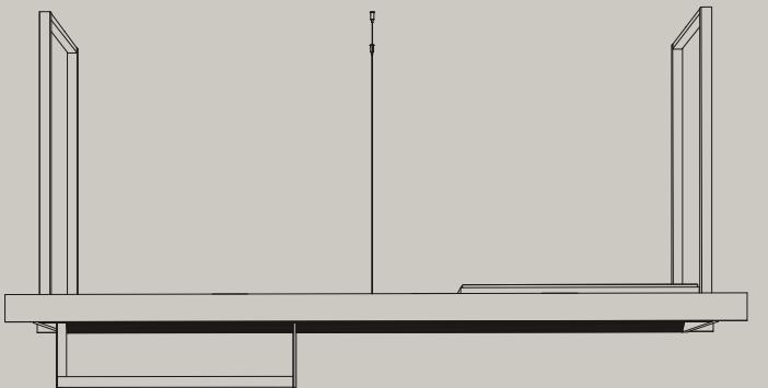
**IT**\_ Un sistema a sospensione modulare composto da un telaio con illuminazione Led integrata. Realizzato con trafil Alu\_Project e da pannelli modulari in vetro Bronzo. Rifinito lateralmente con materiali coordinati con le finiture delle cucine, Ahu\_Sky è disponibile in diverse dimensioni e può essere attrezzato con contenitori a giorno appesi e cappa aspirante filtrante.
