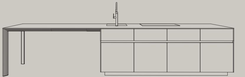
**IT**\_ Il caratteristico profilo Alu\_Project in alluminio inclinato, diviene elemento strutturale per l'ampio piano Alu\_Snack in acciaio satinato complanare al piano di lavoro dell'isola, caratterizzando anche le due gambe di sostegno che possono essere rivestite in diversi materiali coordinati con le finiture della cucina stessa.
