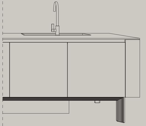
**IT**\_ La struttura Ahu\_Up sospende le basi creando un effetto di leggerezza del monolite funzionale. Il basamento centrale consente il passaggio dei collegamenti idraulici ed elettrici necessari oltre alle eventuali canalizzazioni per le cappe aspiranti integrate. I 4 piedi di supporto possono essere rivestiti con pannelli da 10 mm coordinati con le finiture della cucina. La traipla orizzontale può essere dotata di illuminazione Led integrata.
